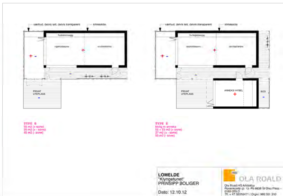
Fig. 28. Boligene består av tre klimatiske soner; klimatisert (+), halvklimalisert (+ -), uterom (-). Tegning: arkitekt Ola Roald.
