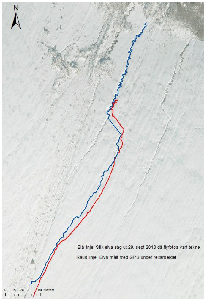
Figur 9.8. Målingar i ArcMap i forhold til i feltarbeid. Raud linje er slik elva såg ut i august 2013 målt med GPS-tracking, blå linje er slik elva såg ut på flyfotoet frå 2010, (norgebilder.no, 2010)
