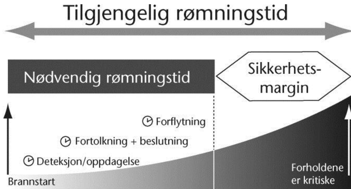
Figur 1: Forhold mellom nødvendig og tilgjengelig rømningstid samt brannforløp (Figur hentet fra Brann og eksplosjonsvernloven, 2002, §2 - 3)
