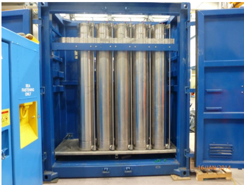
Figur 17 Største akkumulatorflasker i krybber, og med målerør. Privat bilde. (Brukt med tillatelse).
