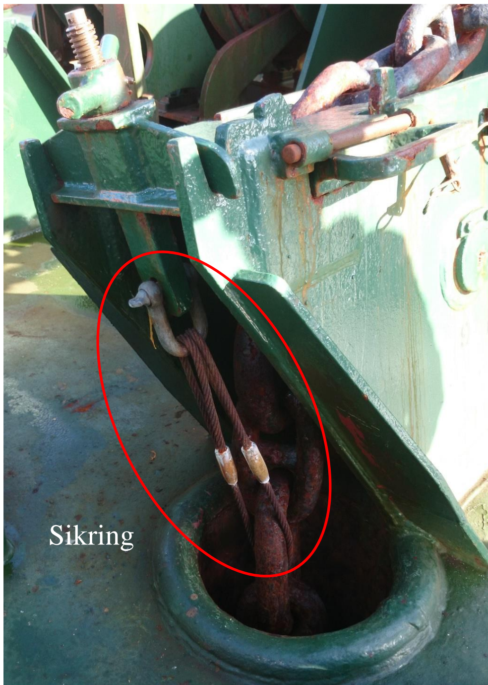
Bilde 2: Ankersikring. Foto: privat.
