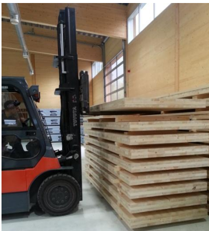
Bilde 2: Truck stabler ferdige elementer
