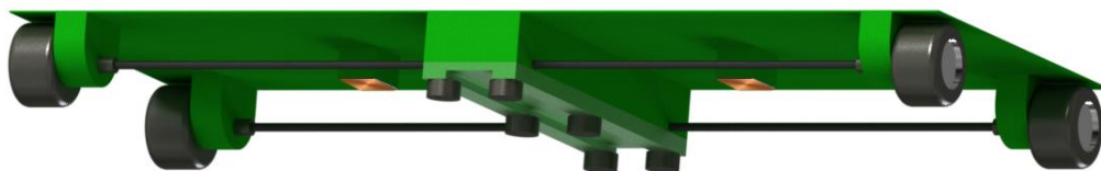
Figur 5 Skisse av konteinarvogn med ladetilkopling styrehjul
