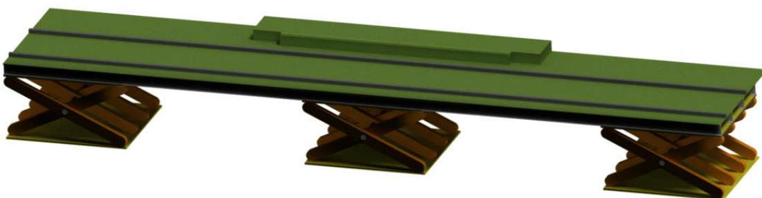
Figur 9 Skisse av plattform på sakseheiser
