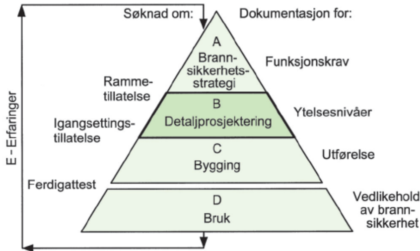
Figur 17 - Detaljprosjektering utarbeides på bakgrunn av brannsikkerhetsstrategi. [3]
