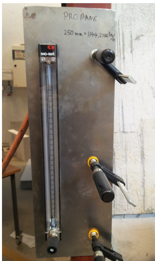
Figur 12: Utstyr for måling av propanstrøm. I forsøkene stod innstrømmen på 110 mm, hvilket tilsvarer en effekt på 30 kW.
