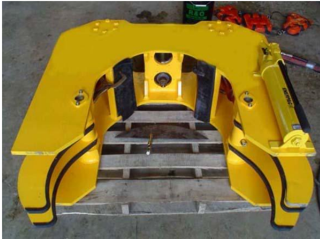
Figur 34 - Mekanisk klemme for tilkopling av HMS3000 mot rørledning (7)
