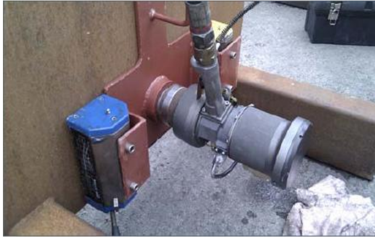
Figur 11 - R1004 verktøyet brukt med magnetklemme til reoperasjon i "splash-sonen" på en FPSO (7)
