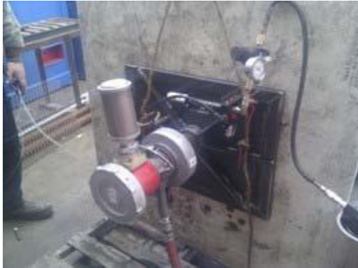
Figur 37 - Vakuumklemme brukt ifm FS ved R1004 verktøyet (7)
