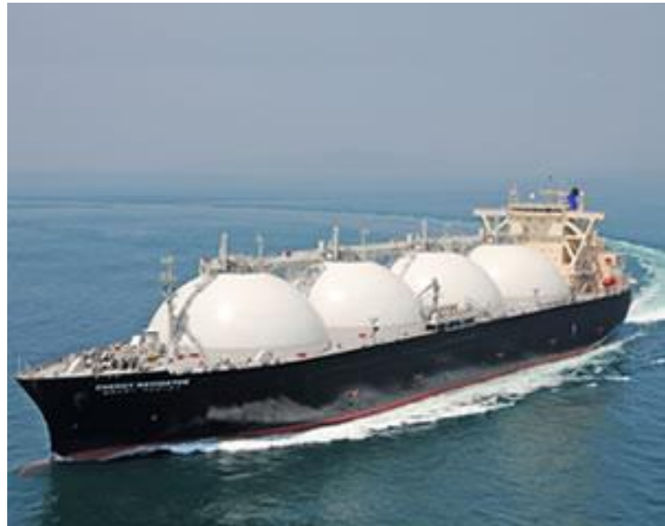
Figur 10: Skip med 4 sfæriske tanker. (Meisei Kogyo)
