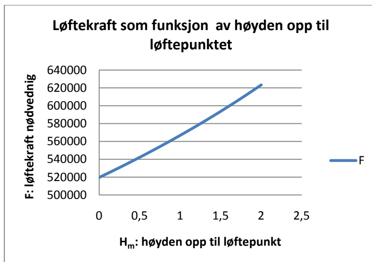
Diagram 3: Nødvendig løftekraft som funksjon av plasseringen av løftepunktet.
