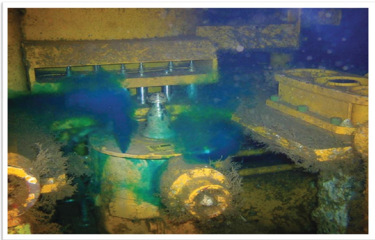
Figur 23 Viser en gasslekkasje ved hjelp av eksitasjonslys og fluoriserende kjemikalier (FOTO: Neptune Oceanographics Ltd)
