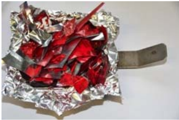
Figur 6.8 Plast med Aluminium på innsiden i begeret klar til forbrenningsforsøket.
