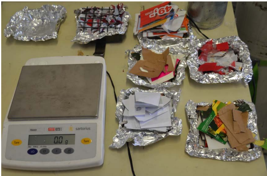
Figur 6.3 Oppe til venstre vises det aluminiumsfolie. Til høyre for denne er et beger med myk plast klargjort til forbrenning, , til høyre for denne en prøve med papir. I midten fra venstre ligger det papp, deretter hard plast.
