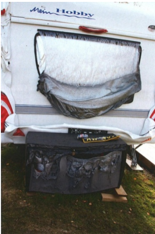
Figur 3-9 Bilde: Smeltet PMMA vindu og putekasse.
