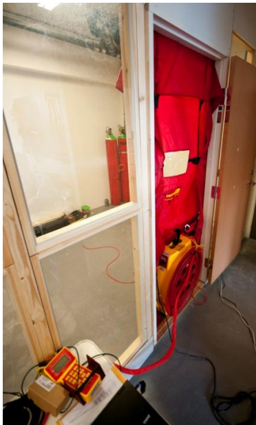
Figur 11: Ventilatordør i forsøksrom (Foto: Aleksandar Nenad Zecevic )
