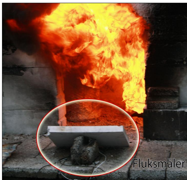
Figur 4-4, Fluksmåling i åpning til ovnen
