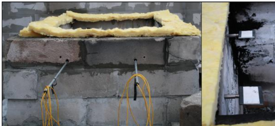
Figur 4-3, To platetermoelementer til venstre i ovnen
