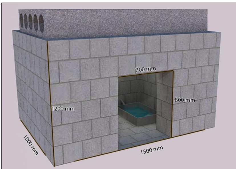
Figur 4-5, Mål på testrigg
