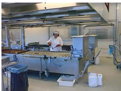
Bilde 6: Steiking av fiskekaker. Her ser en ventilasjonsanlegget i overkant av bildet.
