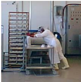
Bilde 3: Skyving av stativ med fiskepudding inn på heiseanordning ved kjølespiralen.
