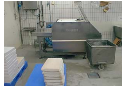
Bilde 2: Hakkemaskin. Her ser en også vognene det kjøres fisk i.
