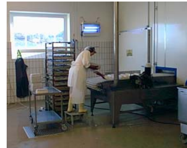
Bilde 4: Fiskepudding legges på kjølespiralen.
