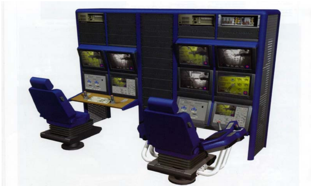
Fig. 2.7.3 viser ROV pilotens arbeidssituasjon ombord i et håndteringsskip. (Bildet er fra kontrollrommet ombord i skipet).
