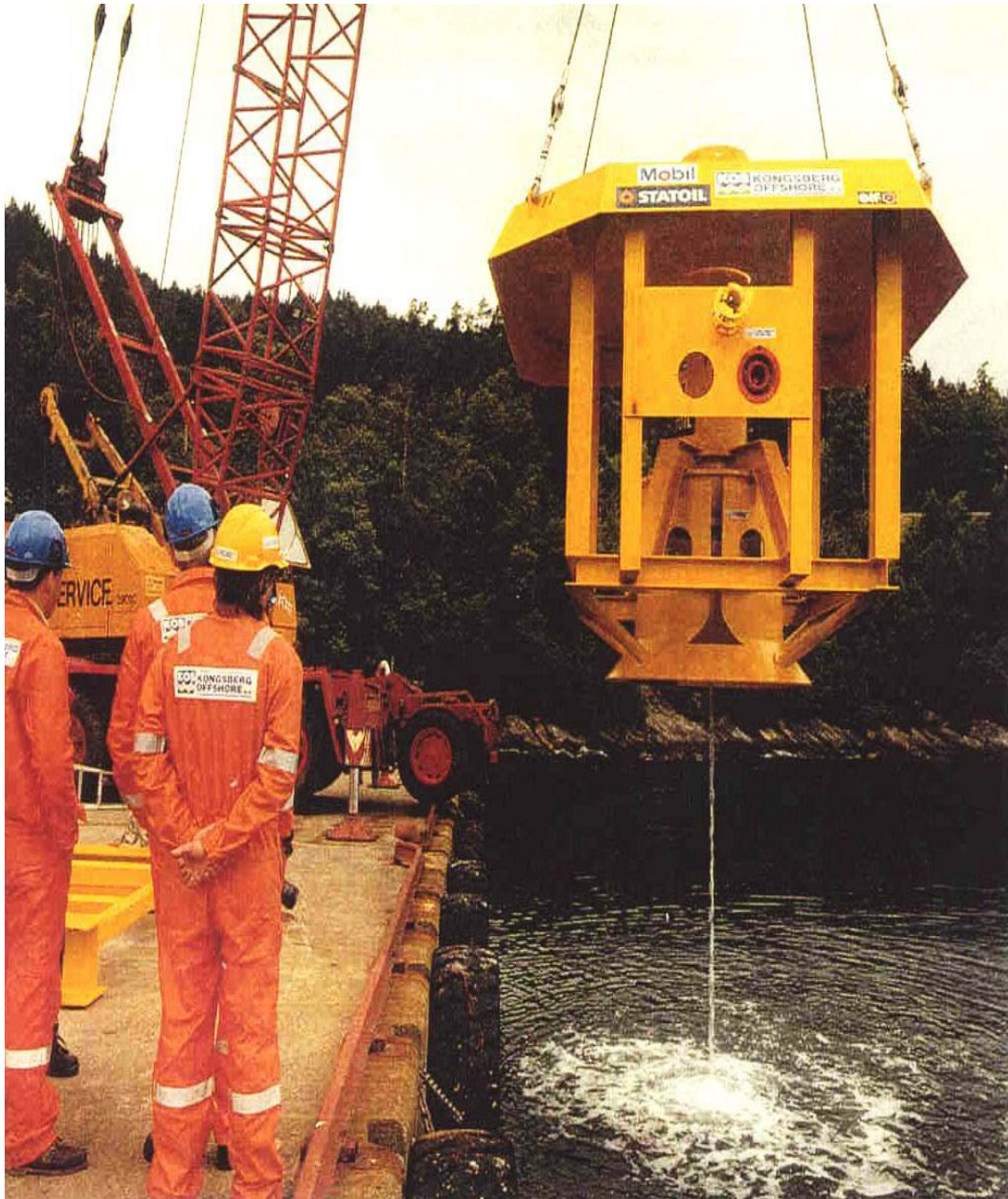
Fig. 2.4.1 viser Kongsbergs Host 2500. Vi ser i forgrunnen orienteringsslissen, som er spesiell for denne metoden.
