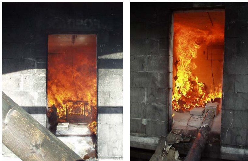
Fig. 4.19 Overtening i rommet.
