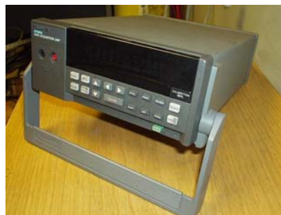
Fig. 3.8 Bilde av dataloggeren som ble benyttet i forsøkene.
