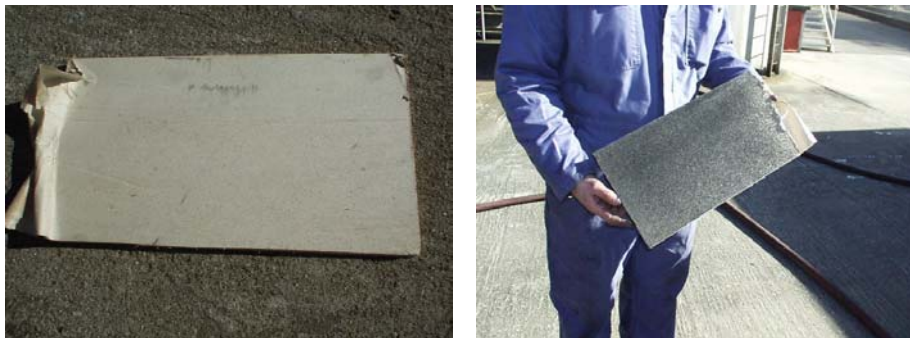
Fig. 4.9 Plate før og etter 30 s på gulvet i brannrommet.
