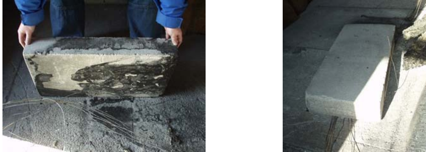
Fig. 3.7 Bilder av hvordan termoelementene var plassert i steinen.
