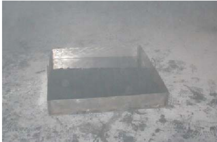
Bild 17. Bränslekar i brandtest D, där en del rökgaserna hänger kvar i tvärorten.
