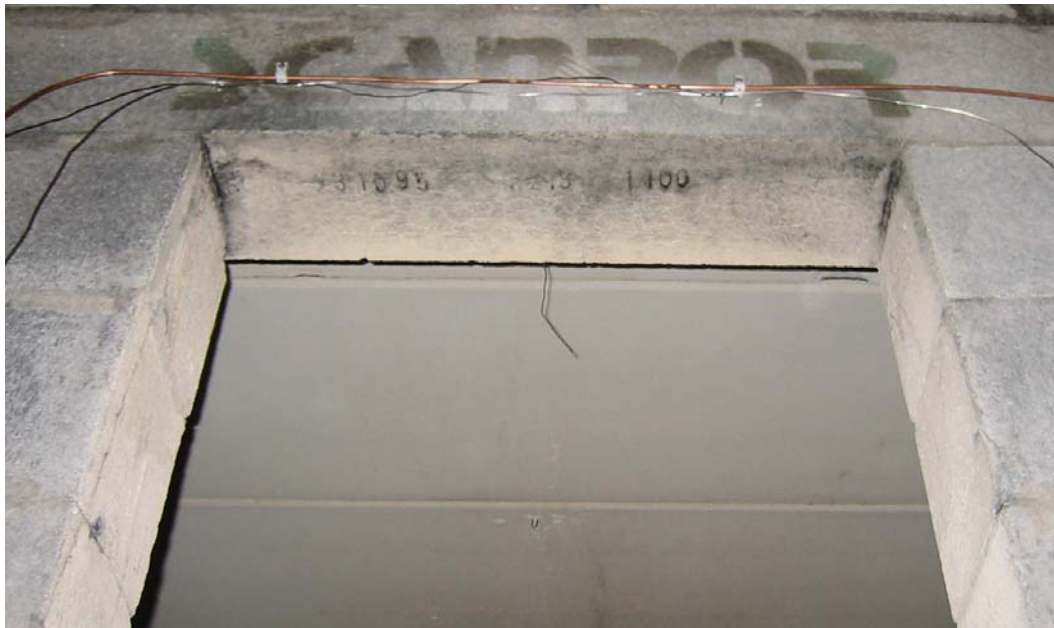
Bilde 3.1.4–1: Plassering av detektorlinjene ved ikke-brann forsøk
