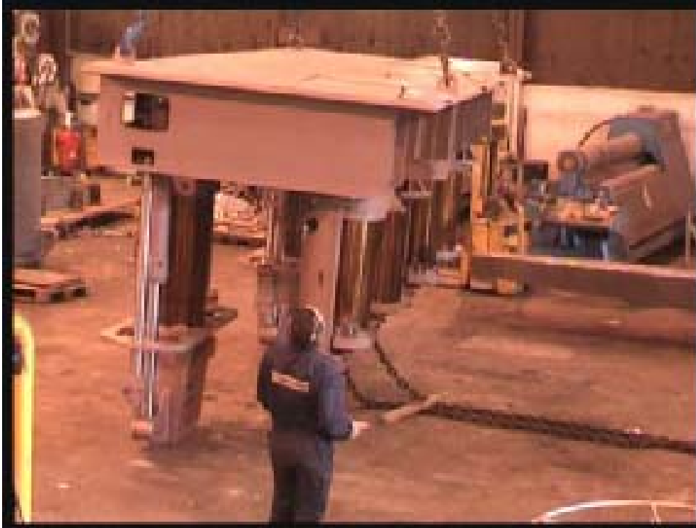
Fig 1.7 Stor Karm Fork på 32000kg.
