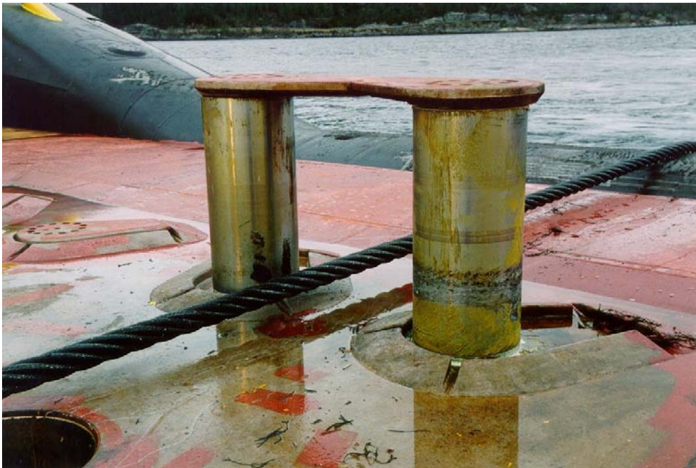
Fig. 1.6 Styrepinner i fullt utslått stilling (til venstre i bildet kan en se en styrepinne som er nedsenket i dekk).
