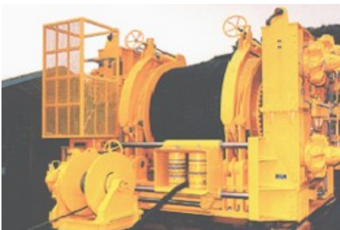
Fig. 1.2 Pull-in vinsj produsert av Karmøy Winch AS.
