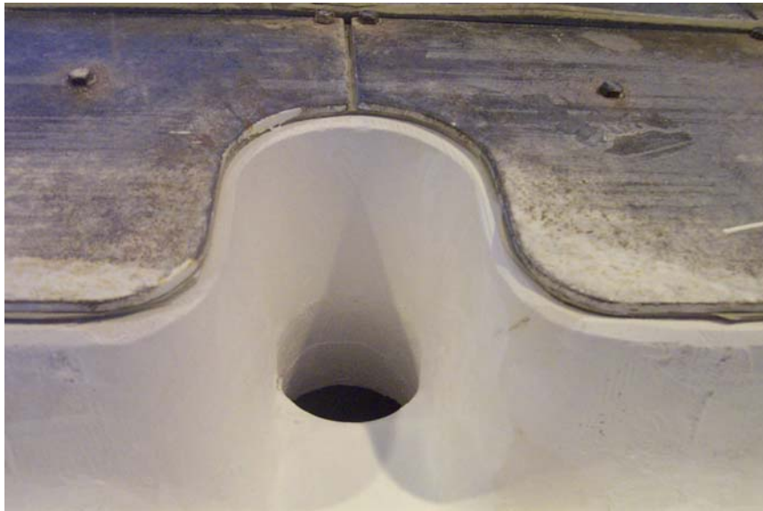
Figur 20. Nedløp til støpeform ferdig vedlikeholdt. (3)
