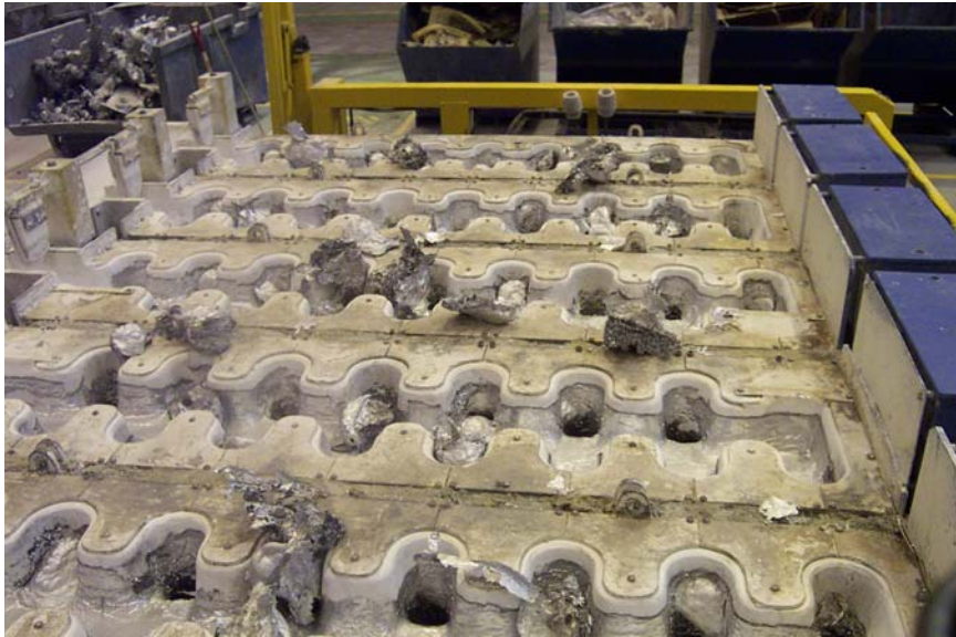
Figur 17. Støpepanne etter støp. (3)
