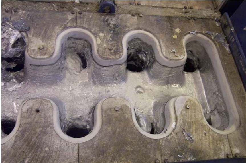
Figur 16. Seksjon i støpebord etter støp. (3)
