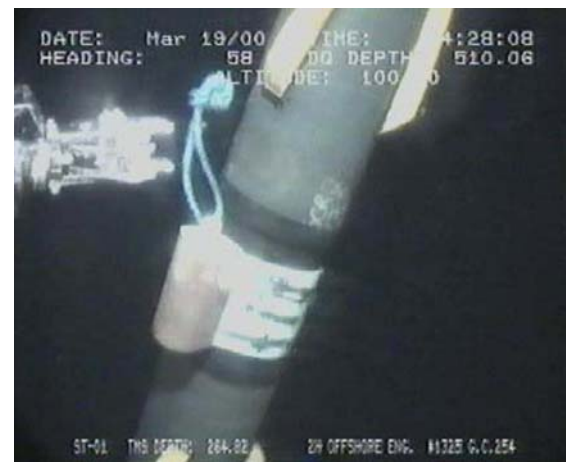
Figur 7.11 Datalogger montert på rør
