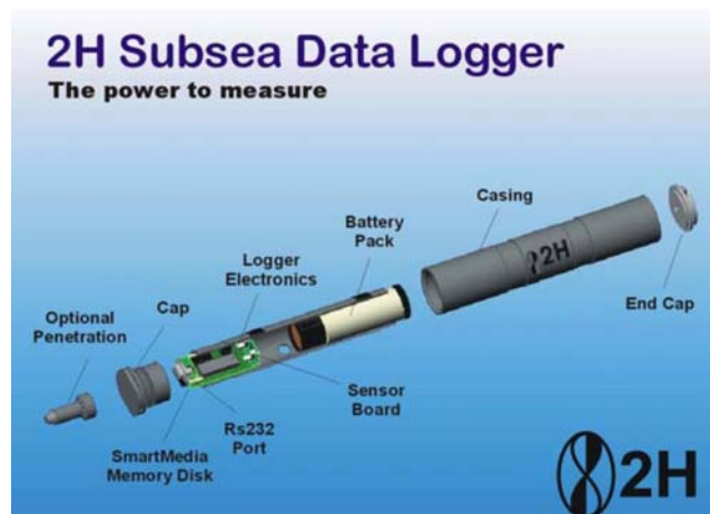
Figur 7.10 "2H Subsea Data Logger" Denne enheten kan utstyres med forskjellig teknologi, blant annet akselerator.
