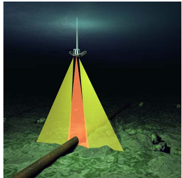
Figur 7.4 Sonarsystem. SVS 3 Beam system sveiper over en rørledning med 60° vinkel.
