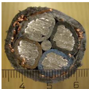
Figur 4: 30 mm med 4 aluminiumsledere.
