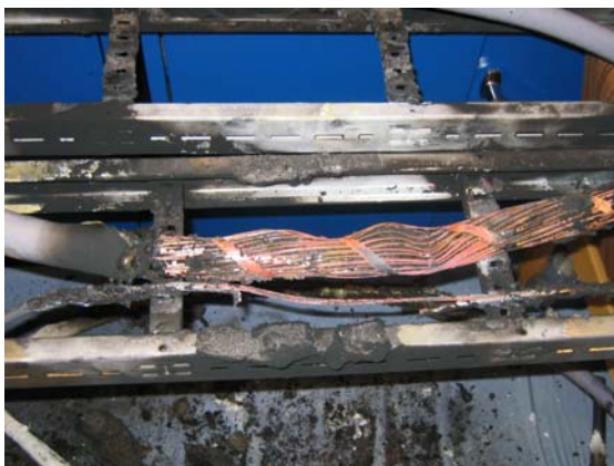
Figur 9: Eksempel på 40 mm kabel uten brannhemmende maling som er eksponert for brann i 15 minutter. Spredning er målt ut i fra berørt område.
