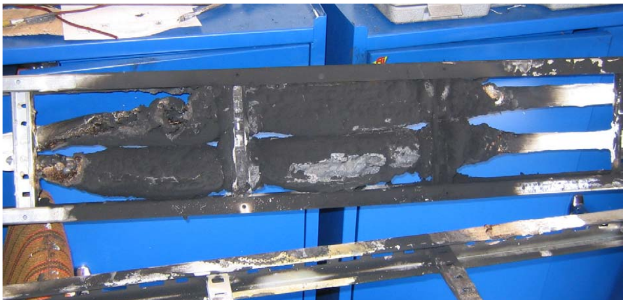
Vedlegg 15: Kabler med brannhemmende maling etter 15 min branneksporing.
