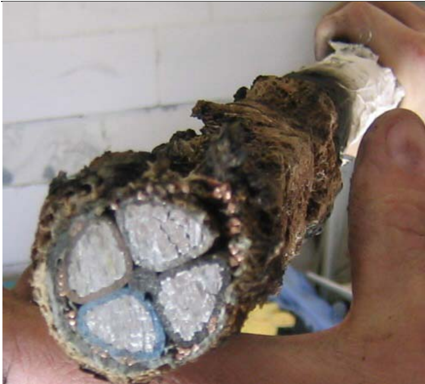
Vedlegg 12: Tverrsnitt av 40 mm kabel med maling etter eksponering i 15 min.
