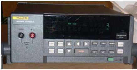
Figur7: Bildet viser dataloggeren, Fluke Hydra 2620.
