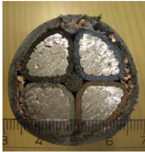
Figur 5: 40 mm med 4 aluminiumsledere.
