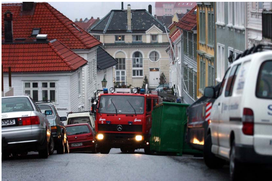
Figur 21: Parkerte biler og containere hindrer brannvesnets utrykningskjøretøyer. Gatene på dette bildet er over dobbelt så brede som mange av gatene i brannsmitteområdene. (Foto: Fred Ivar Klemetsen – Bergens Tidende)
