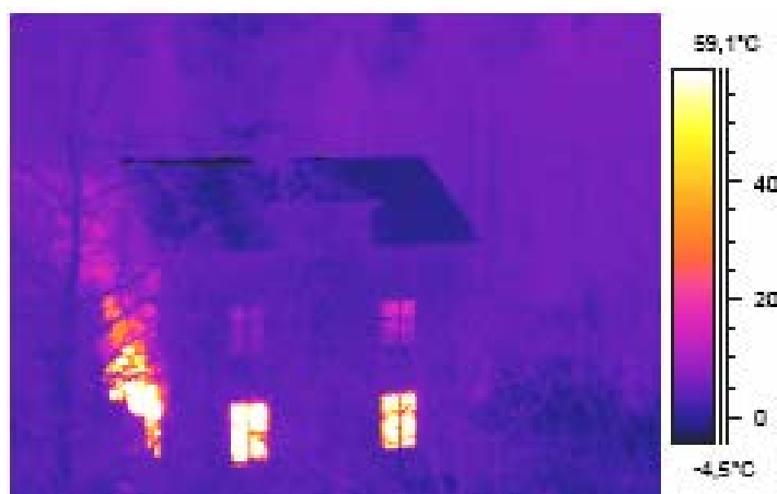
Figur 12: Varmefoto av test hus på Svorkmo [37].
