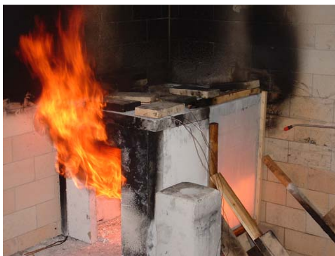
Figur 17: Bilde viser effekten til FRS under et forsøk gjennomført ved Høgskolen Stord/Haugesund, 2004. Gardinen er montert til høyre på konstruksjonen. (Jon Ivar Utstrand og Rune Kyllenstjerna)
