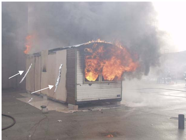
Figur 10 Tidlig i brannforløpet. Termoelementene ses til venstre (piler).
