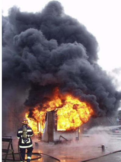
Figur 12 Stor røykutvikling. Betongen kjøles.
