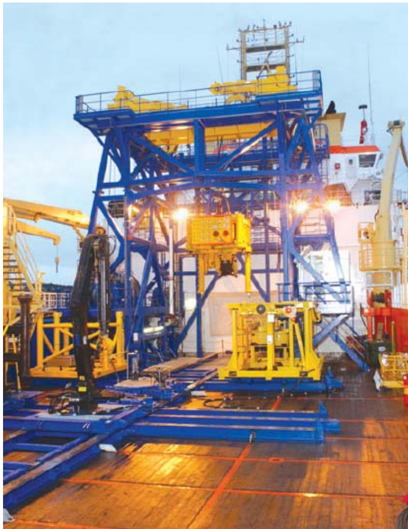
Figur 2.3.1 Bildet viser MHS som betjener FCM og FCMRT samt "Skidding System"[1]
