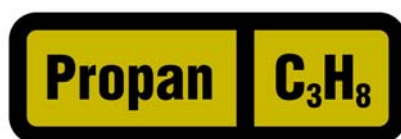
Bilde 6: Merking av propan rør
