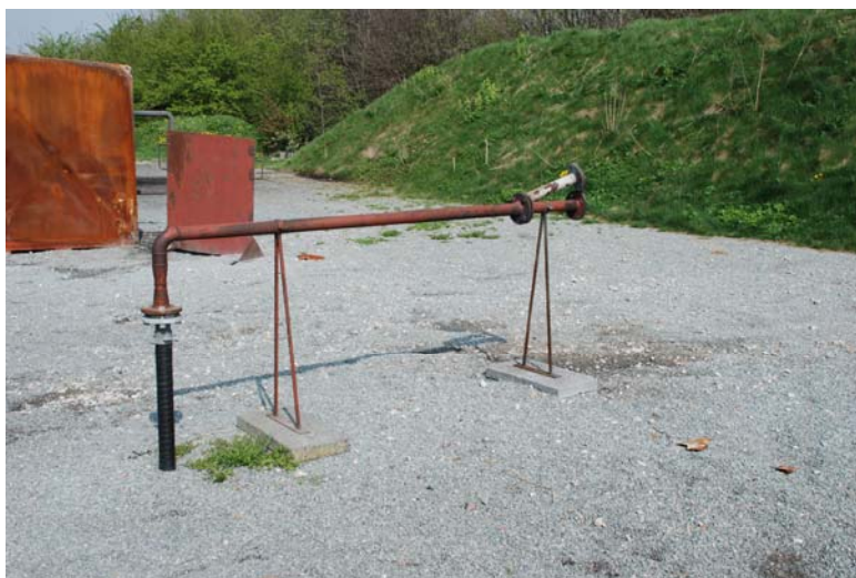
Bilde 19: Øvelsesfelt til flensbrann/rørbruddsbrann [27]
