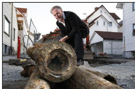
Figur 8 Gamle vannledninger som ble skiftet ut i Stavanger i mai 2008. Foto Pål Christensen. (Vannrør)
