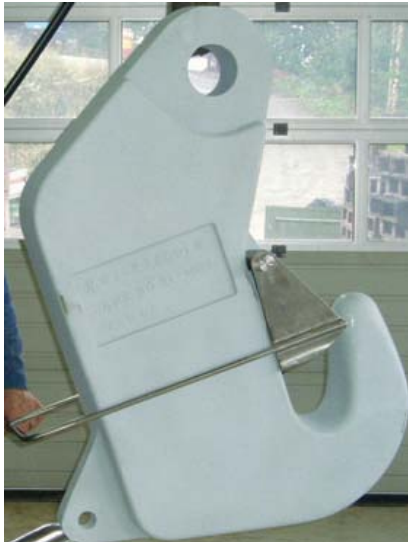
FIGUR 3.3.1.4 IMENCO/MØLLERODDENS KROK FOR LØFT UNDER VANN [8]
