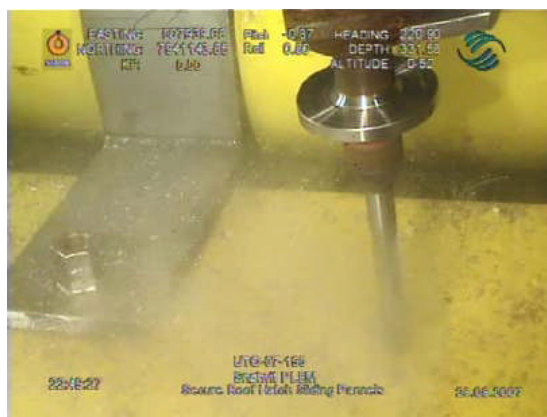
Figur 6.2 Boring av hull [11]
