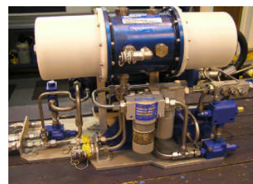
Figur 7.2 Bennex DWP med ventiler, kompensator og filtre [13]
