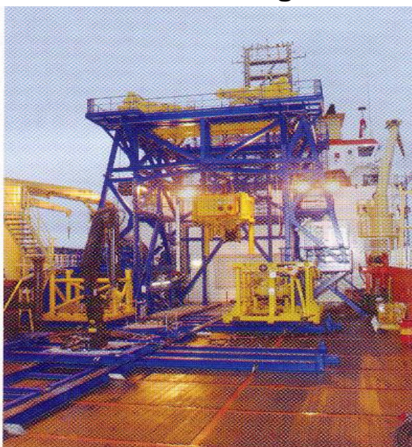
Fig 2.1 Modul Håndterings System med "skids" ·[26]
