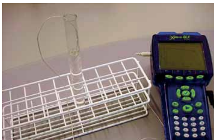
Figur 1: Avkjøling av varmt vatn. Måling med Xplorer GLX dataloggar frå Pasco og ein temperatursensor. NB! Bruk av reagensglas gjev best resultat.
