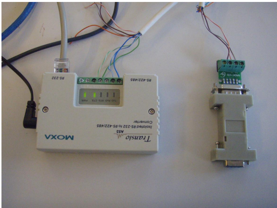
Figur 25 RS232 til RS485 konverterane. Skulen sin til venstre og prosjektgruppa sin til høgre.
