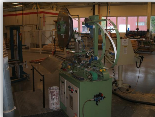
Figur 33: Maskin for treing av toppglider
