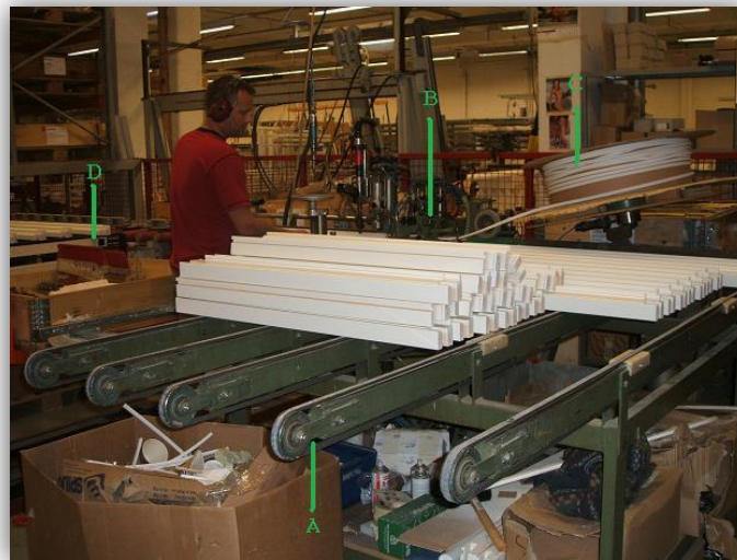
Figur 29: Montering av glidehengsler og treing av pakning
