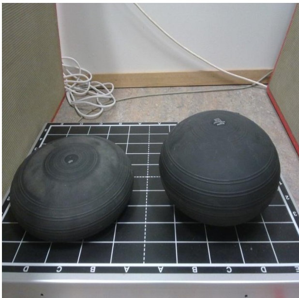
Bildet 2: Bildet viser kraftplattformen, og de to ulike putene vi brukte på de forskjellige testene, liten og stor pute.
