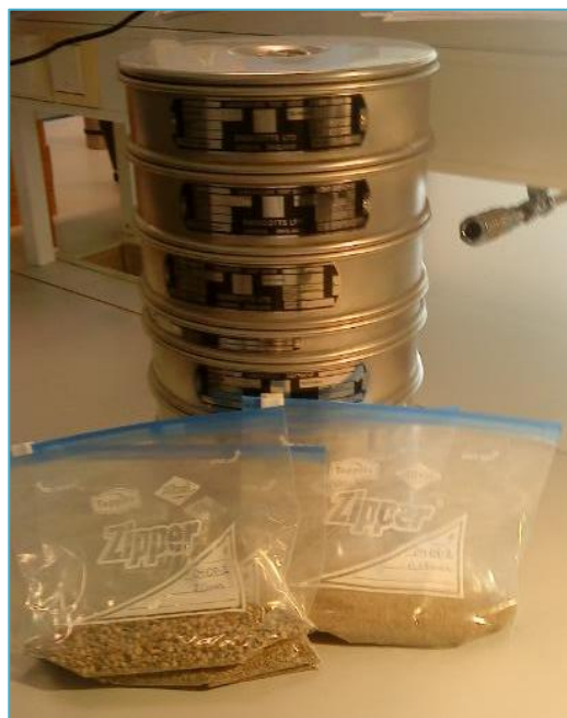
Bilete 7: Siktesatsen og nokre av posane med ferdigsikta materiale.
