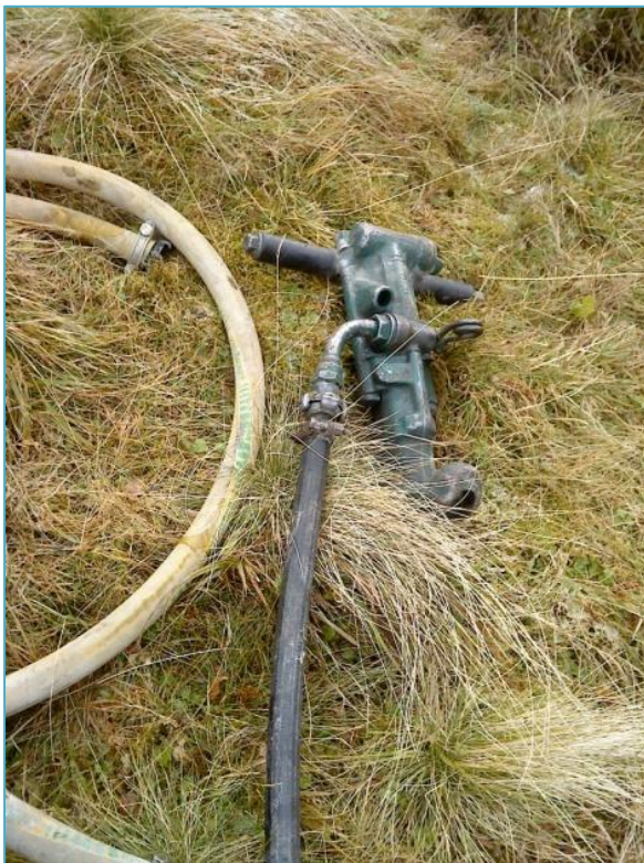
Bilete 5: Borehammaren og litt av trykkluftsslangen.
