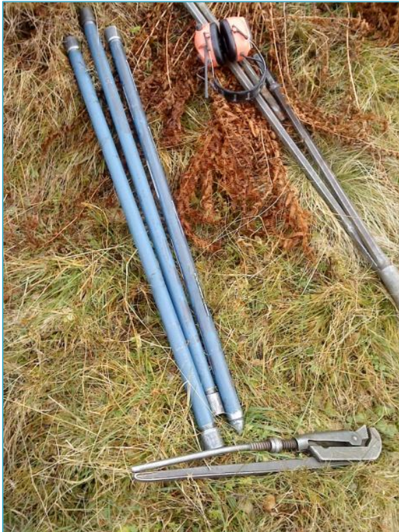
Bilete 4: Slissa røyr med spiss, skøyterøyr, borestenger og røyr tang.
