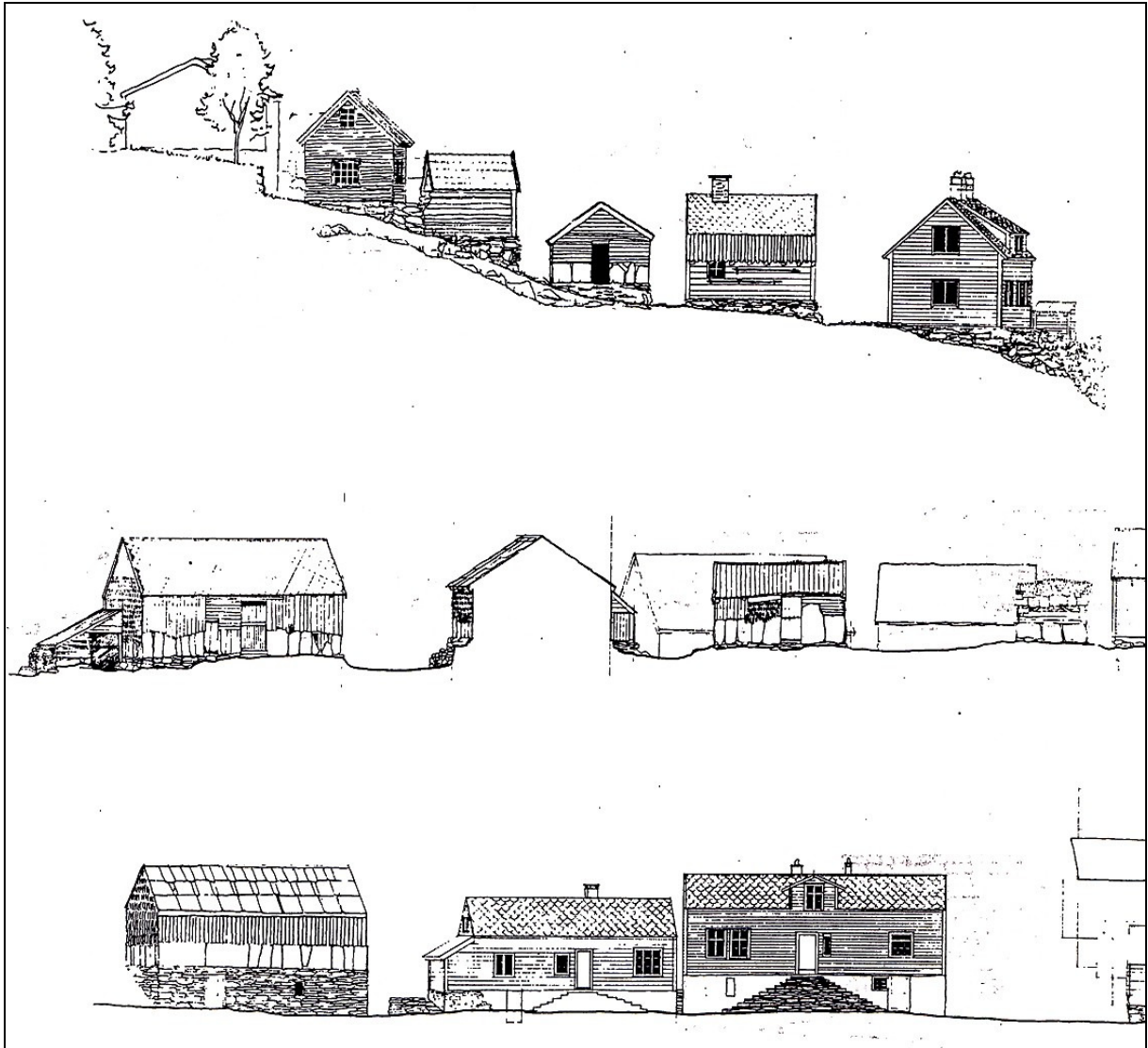
Fig. 2. Et utvalg skisser av gateløpene i klyngetunet Havrå på Osterøy, Hordaland fylke.. Skissene viser hvorledes kjellere bygges inn i bakken. På nedsiden har flere av bolighusene høge trapper da terrengforholdene er jevnet ut for å få horisontale vegger/plasser mellom bolighusene. Skrånende terreng gir også gode usiktsforhold (påbygde arker i andre etasje). Tegningene er hentet fra publikasjonen "To tun i Vestnorge" (Dahl 1994).
