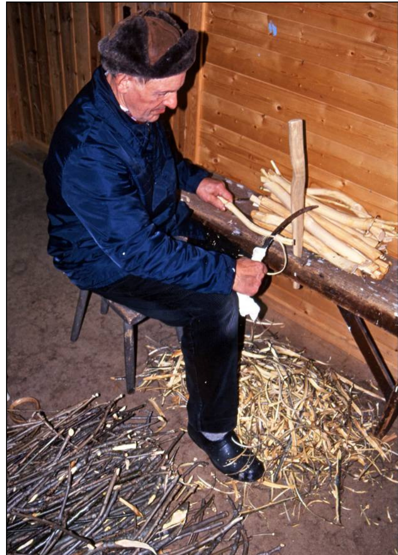
Fig. 42. Johannes Torp skaver en "skjevling". Redskapet er en gammel lå som det er satt håndtak på.
