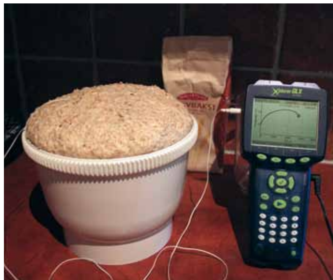
Figur 8: Ein ferdig heva brøddeig der deigtemperaturen har blitt logga i hevingssperioden. Etter at temperatursensoren var nappa ut, vart brøda forma til og steikte.
